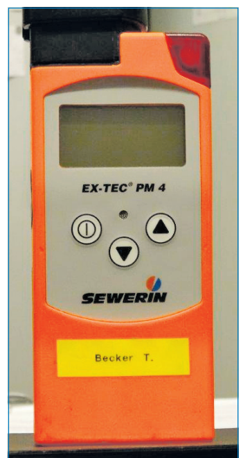
Mit dem Gasspürgerät messen Mitarbeiter der Stadtwerke Völklingen die Volumenprozent in der Luft, können so Undichtigkeiten an Gasleitungen aufspüren. Fotos: tb
